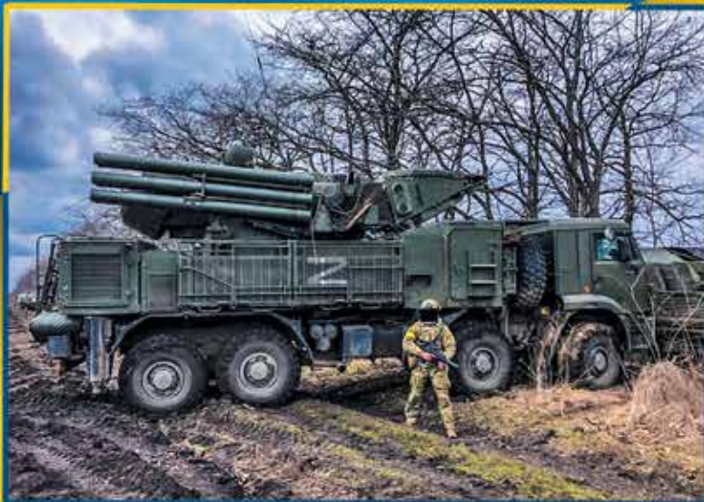
Воїн ЗСУ перед захопленням в березні 2022 р. новітнім російським самохідним зенітним ракетно-гарматним комплексом (ЗРГК) наземного базування «Панцирь-С1» (фото з інтернету)
